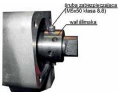
Rys. 5. Sposób wymiany śruby zabezpieczającej przenośnik ślimakowy – widok z boku
